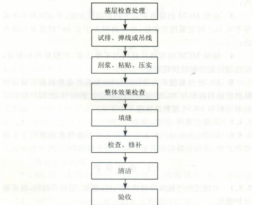
图 5.4.1 MCM 建筑饰面工程施工工序
