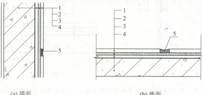
图 4.2.1 MCM 直接粘贴于墙面、地面基层的构造示意
