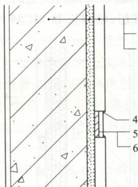
图 4.2.4 金属片嵌缝构造示意
