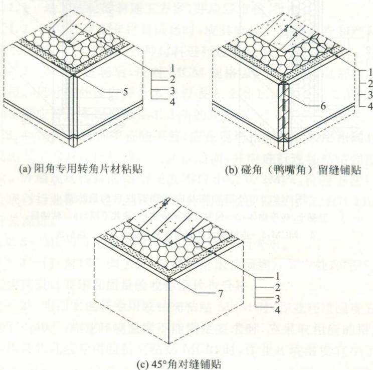
图 4.2.6 MCM 阳角铺贴构造示意
