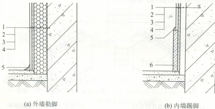
图 4.2.9 外墙勒脚及内墙踢脚收口构造示意
