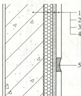
图 4.2.2 MCM 粘贴在保温系统抹面层上的构造示意
